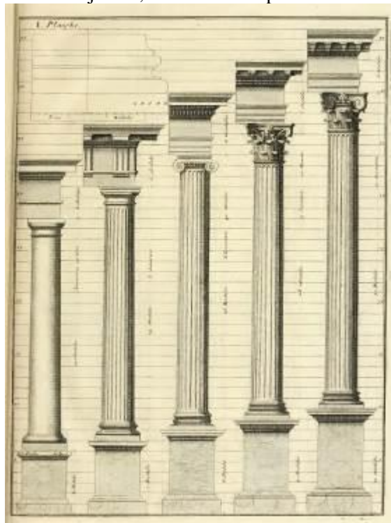
Figura 145 - Coluna das ordens da arquitetura romana da esquerda para direita: toscana, dórica, jônica, coríntia e compósita
