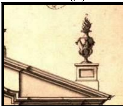
Figura 232 - Vaso-fogaréu no frontão da Igreja de São João Batista, Belém, Pará
