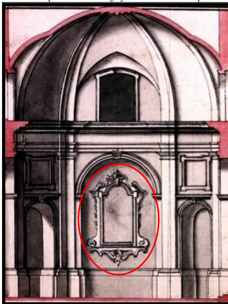
Figura 241 - Detalhe da parede lateral da Igreja com moldura e não pintura de quadratura
