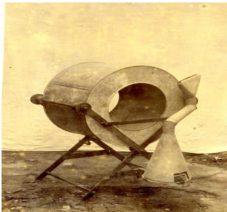
Figura 9 – Máquina de Defumar Borracha, patenteada pela firma paraense Danin & Mello e baseada no processo de preparo da borracha “Vianna Coutinho”, aperfeiçoado .
