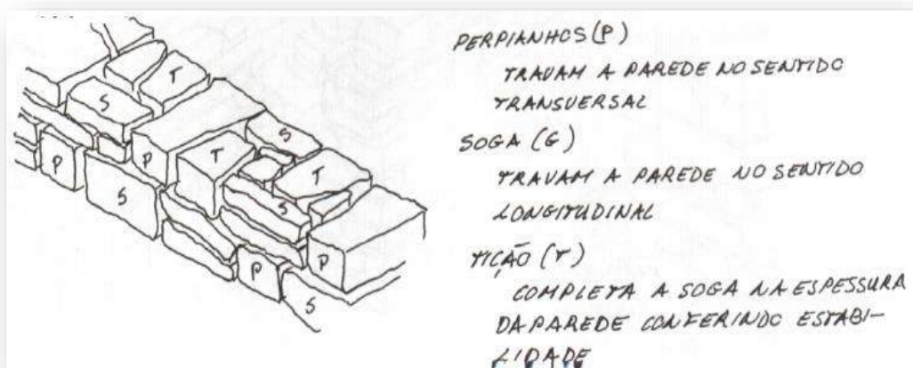
Figura 109 - Travamento dos paramentos das paredes de pedra
